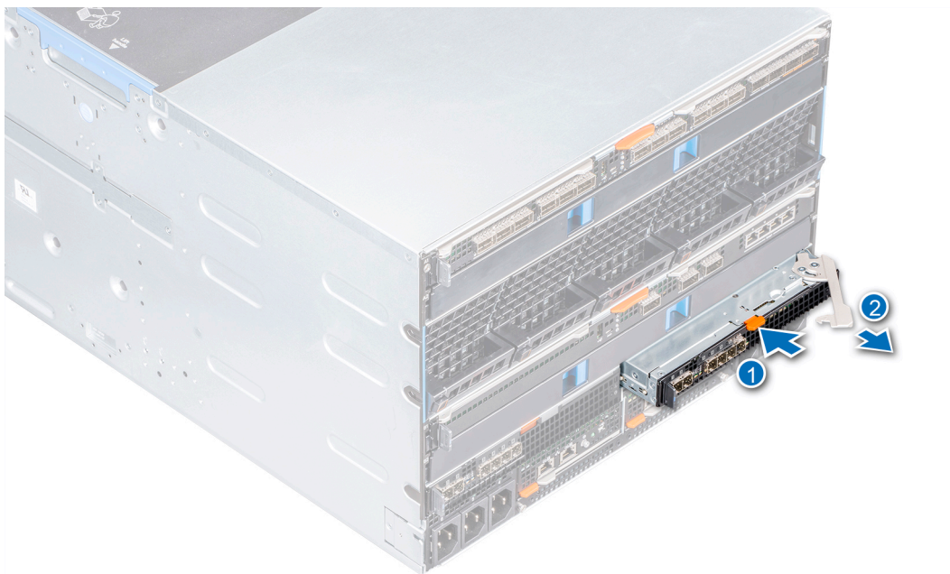
図 24. Fabric C スロットから MX5016s モジュールを取り外す
