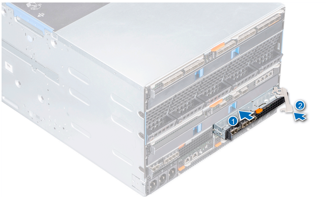
図 25. Fabric C スロットに MX5016s モジュールを取り付ける
